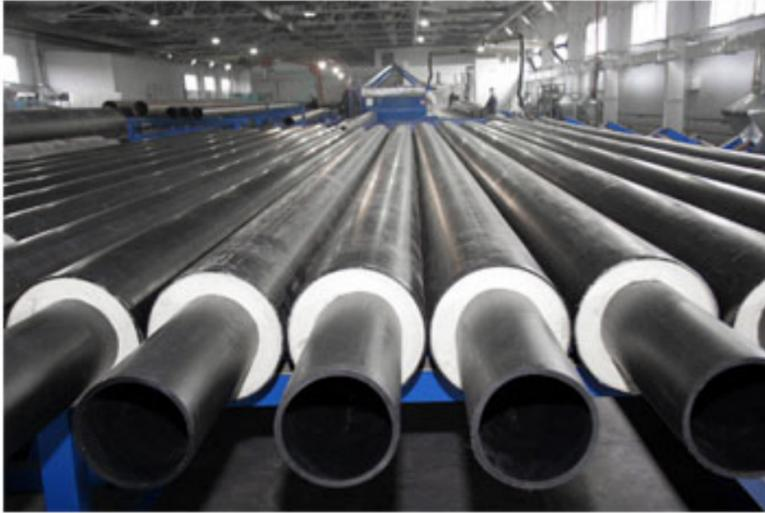
Вся без исключения продукция, выпускаемая ООО «ВАДИС-центр», снабжается проводами системы оперативного дистанционного контроля (СОДК) протечек. Использование СОДК при эксплуатации трубопроводов существенно повышает их надежность, позволяет своевременно обнаруживать и устранять небольшие повреждения.
