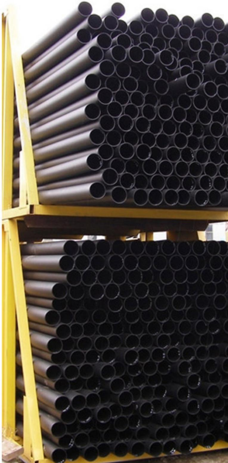
Трубы-оболочки изготавливаются только из полиэтилена ПЭ80, ПЭ100 черного цвета по ГОСТ 30732-2006 и СП.248-004-45127991-07 без добавления вторичного сырья на современном высокотехнологичном оборудовании: экструзионной линии CINCINNATI EXTRUSION Австрия. Это позволяет нам гарантировать высокий уровень качества выпускаемой продукции.
